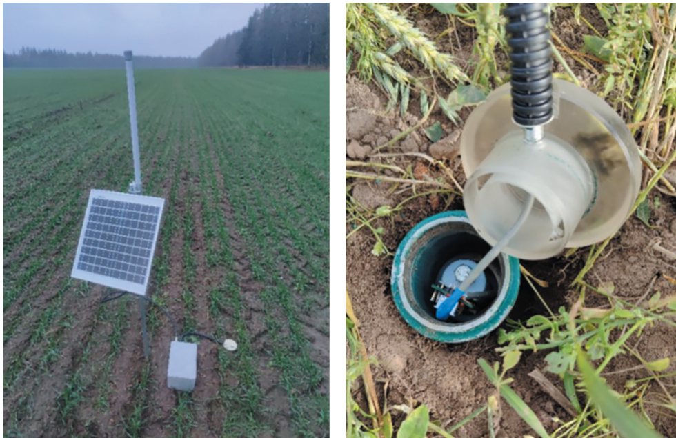
Рис. 3. Сенсорный узел с солнечной панелью, антенной, блоком питания, пятиканальным влагомером, установленным в обсадной трубе (справа)
