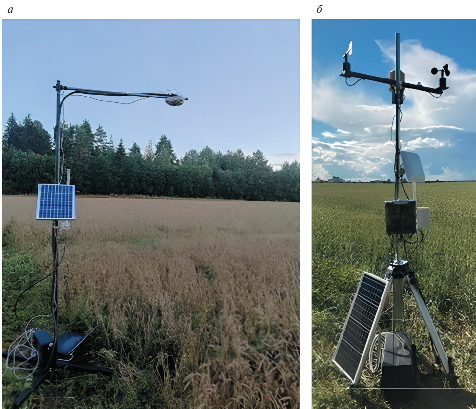
Рис. 1. Сенсорный узел (а), оснащённый оптическим датчиком для мониторинга состояния растительности, и базовая станция с интернет-каналом передачи данных для мониторинга метеорологических параметров (б)
