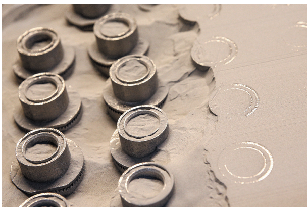
Рис. 1. Завихритель фронтального устройства камеры сгорания двигателя ПД-14, изготовленный методом аддитивных технологий
